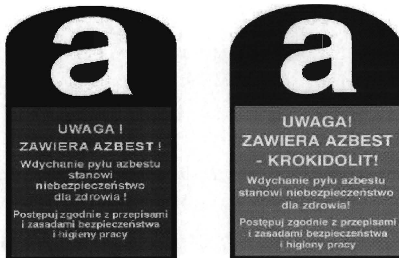
Rys. 3 Oznakowanie wyrobów i odpadów zawierających azbest, wysokość znaku powinna wynosić co najmniej 5 cm, a szerokość co najmniej 3 cm.
