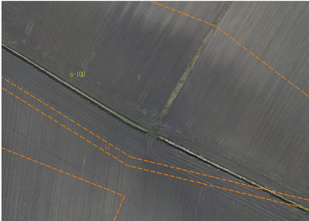
Fot. 31. Rów melioracyjny w dobrym stanie, przebieg niezgodny z ewidencją gruntów i budynków - wieś Gzy.
