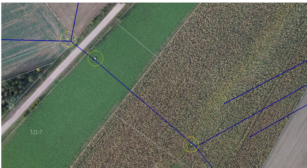
Fot. 34. Inwentaryzacja studni drenarskich – wieś Przewodowo-Parcele.
