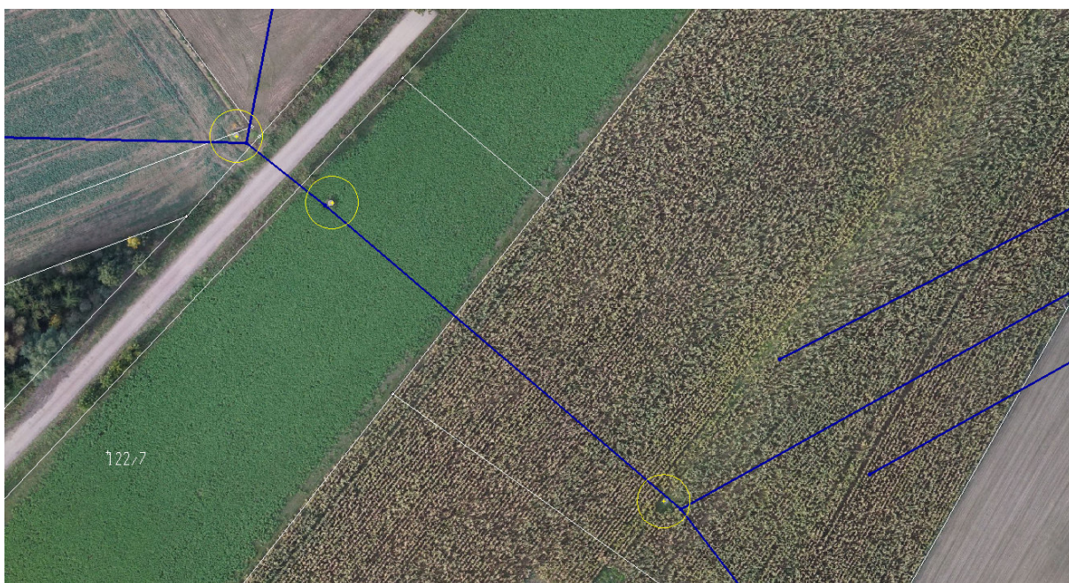
Fot. 34. Inwentaryzacja studni drenarskich – wieś Przewodowo-Parcele.
