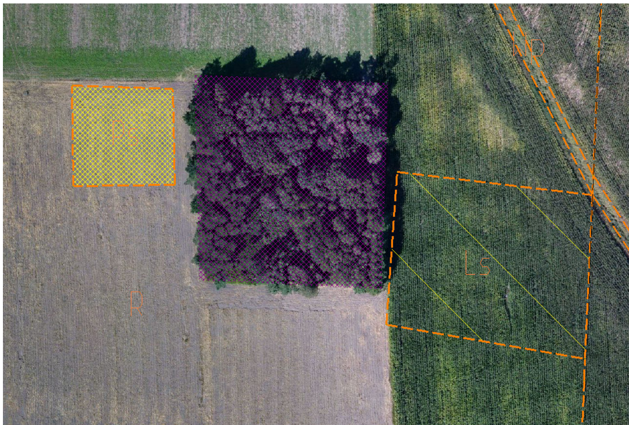
Fot. 11. Rozbieżność między stanem faktycznym a ewidencją gruntów i budynków – wieś Ostaszewo-Pańki.
