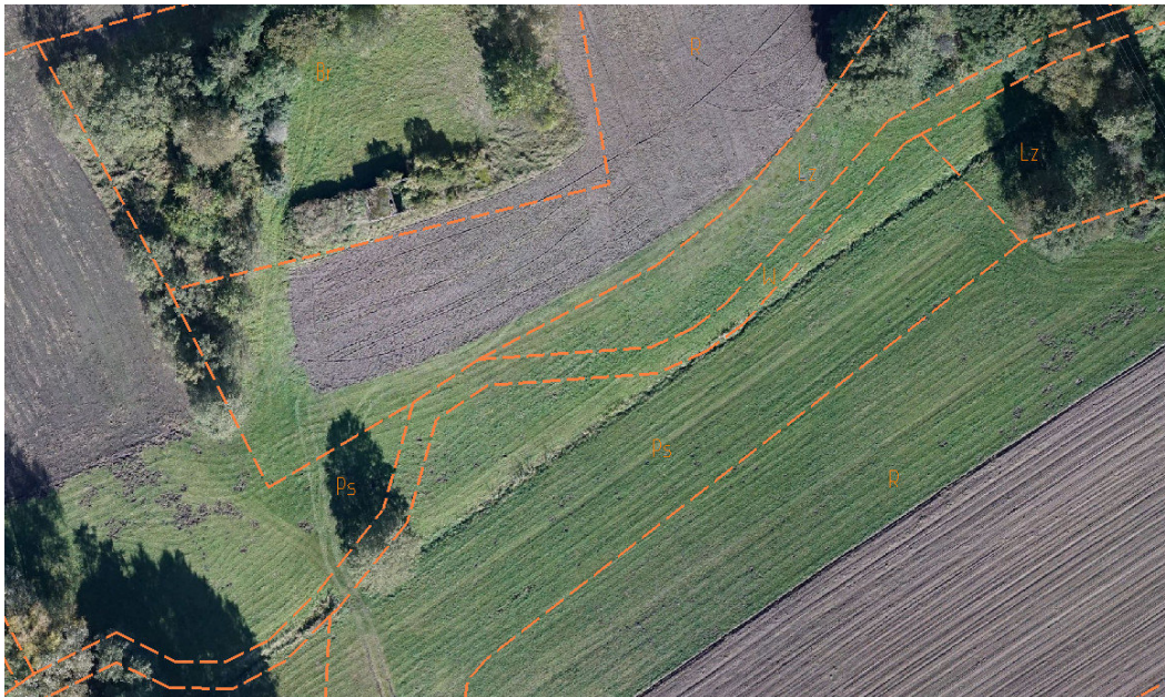
Fot. 32. Rów melioracyjny przebieg niezgodny z ewidencją gruntów i budynków - wieś Kęsy Wypychy.
